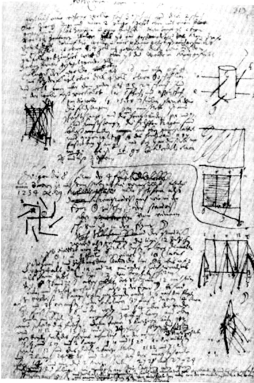
Figura 5.2. Diseño de Leibniz de un molino de viento horizontal, incluyendo el trazado de los paneles rotatorios y las cubiertas direccionales. L. H. XXXVIII, B1 313. (Por cortesía de la Niedersächsische Landesbibliothek, Hannover.)
